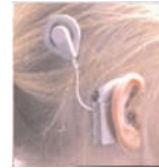
Figuur 2. Extern gedeelte van een CI.
